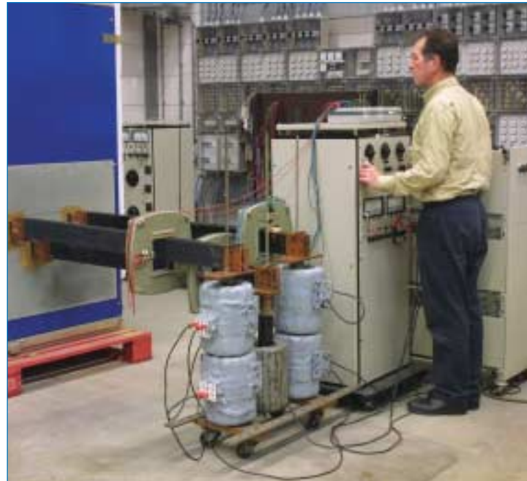
Temperatuurstijgingstest in het Prof. Ir. Damstra Laboratorium.
